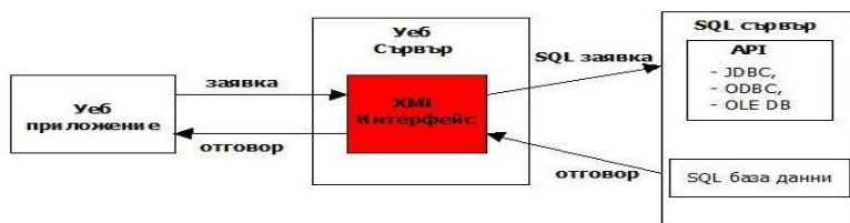
Фигура. 1. Интеграция на уеб-системи чрез SQL база данни посредством XML интерфейс
